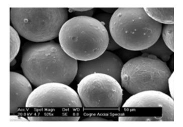
La polvere COGNE è atomizzata e raffreddata in atmosfera inerte di azoto. Questo processo permette a COGNE di produrre particelle sferiche con una composizione chimica uniforme e con basso tenore di ossigeno. La polvere è vagliata utilizzando vagli ad ultrasuoni in modo da ottenere una distribuzione granulometrica precisa e adatta a tutte le applicazioni.
